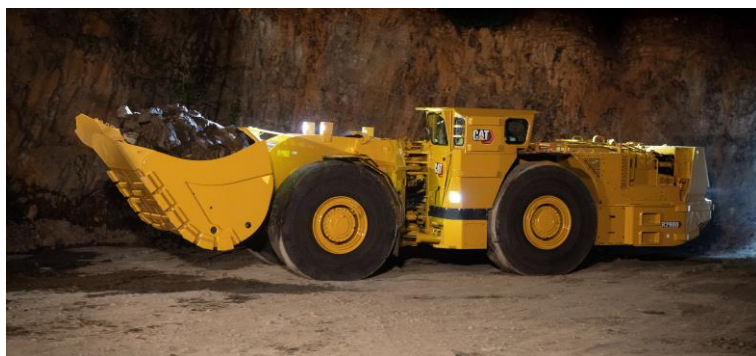
Сл.48 Товарачко -транспортна машина на дизел погон за подземни рудници
