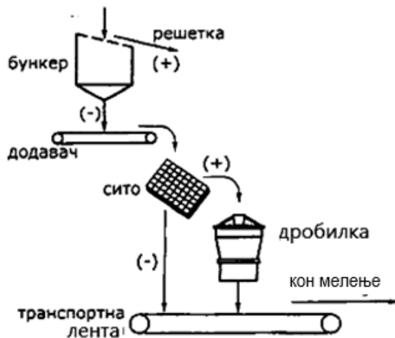
Сл.50 Шема на постапка на дробење и сеење
