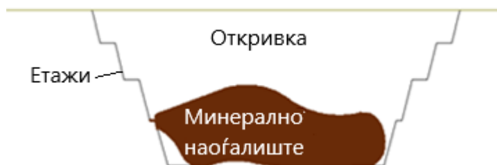
Сл.52 Положба на откривката во однос на минералното наоѓалиште.
