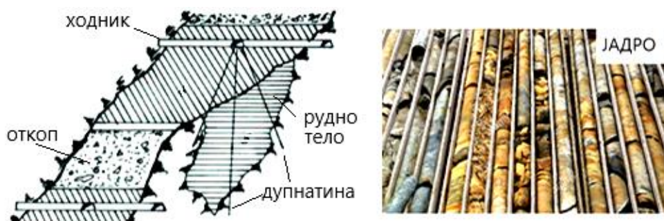
Сл.51 Истражување со подземни рударски простории и со длабинско дупчење
