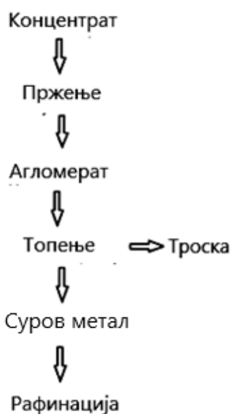
Сл.85 Шема на технолошки процес на добивање метали
