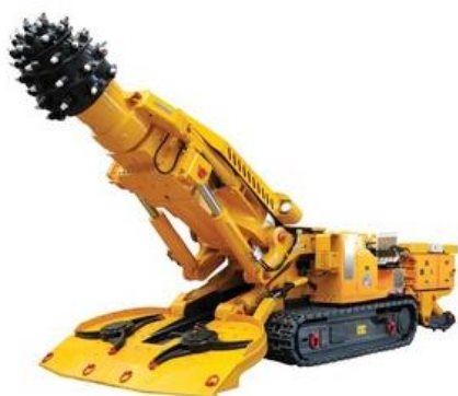
Сл.47 Машини за копање во подземни рудници на јаглен
