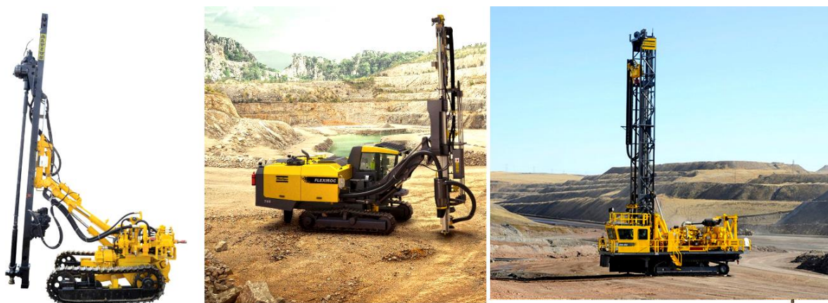
Сл. 43 Дупчалки за дупчење на долги мински дупнатини на површински рудници
