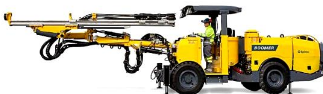
Сл. 46 Рачна дупчалка и механизирана дупчалка за подземни рудници
