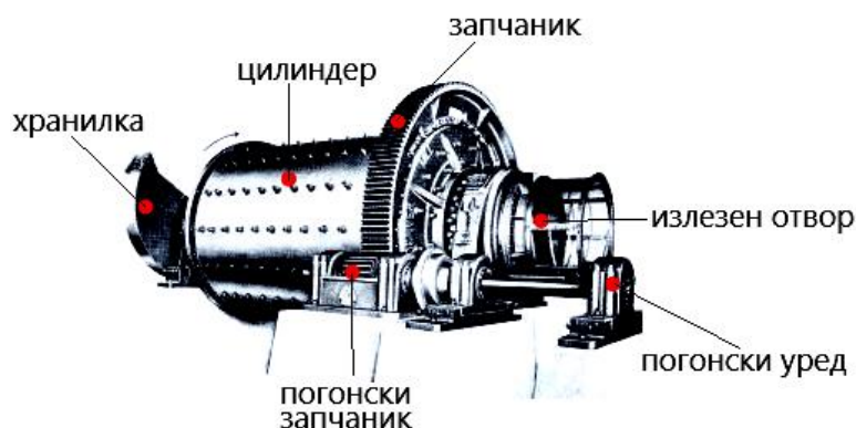
Сл.72 Надворешен изглед на цилиндрична мелница
