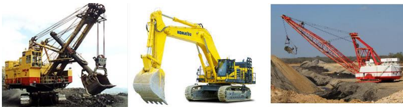
Сл.44 Багер лажичар со јаже, хидрауличен багер лажичар и багер дреглајн за површински рудници
