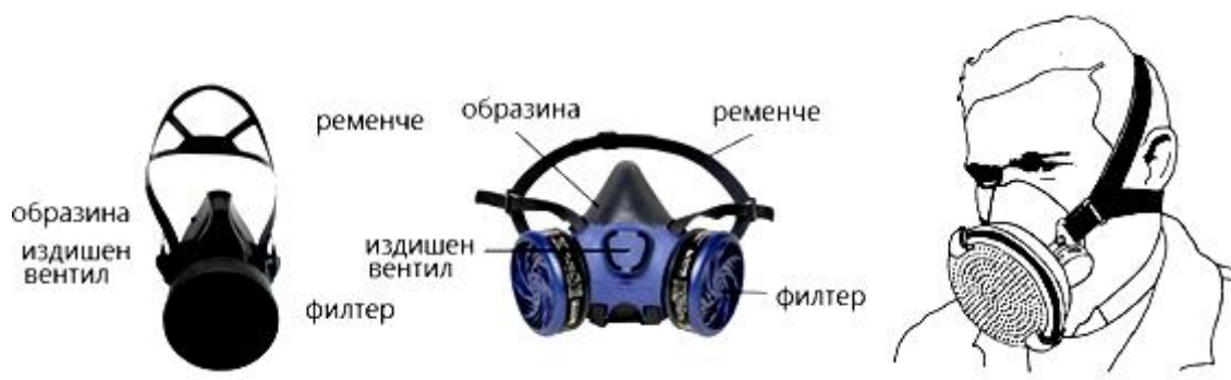
Сл.82 Респиратори со еден и со два филтери
