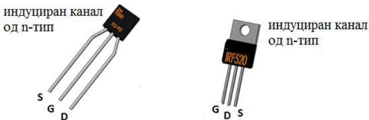
Слика 1.23: Приклучоци на MOSFET транзистори
