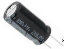
Слика 15: Означување на електролитскиот кондензатор
