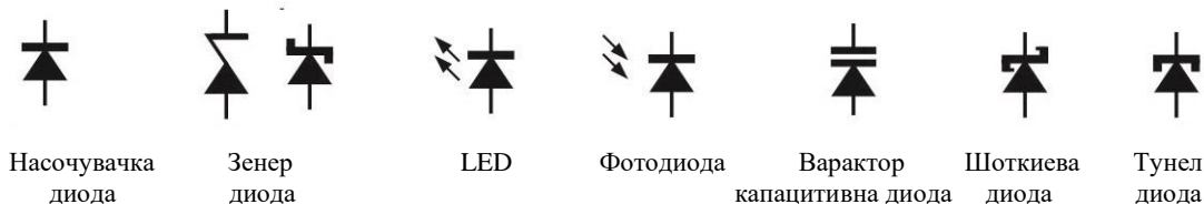
Слика 2.11: Шематски приказ на видови полупроводнички диоди
