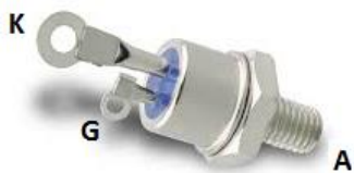
Слика 1.28: Приклучоци на SCR тиристор
