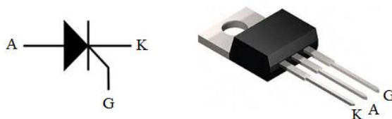
Слика 1.27: Графички симбол и приклучоци на тиристор
