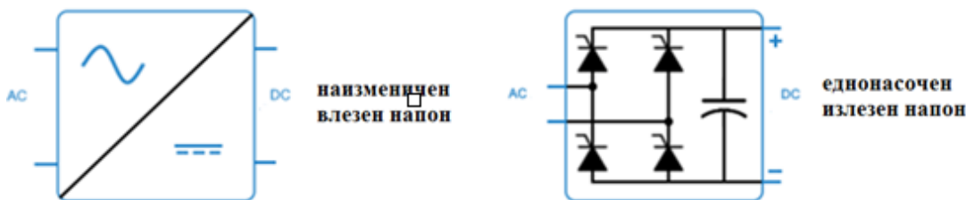
Слика 6.3: Графички симбол и коло на AC/DC претворувач
