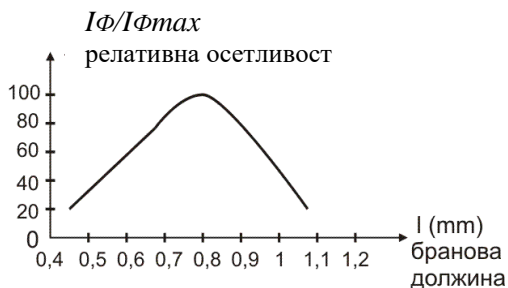
Слика 5.11: Карактеристика на релативна осетливост на фототранзистор
