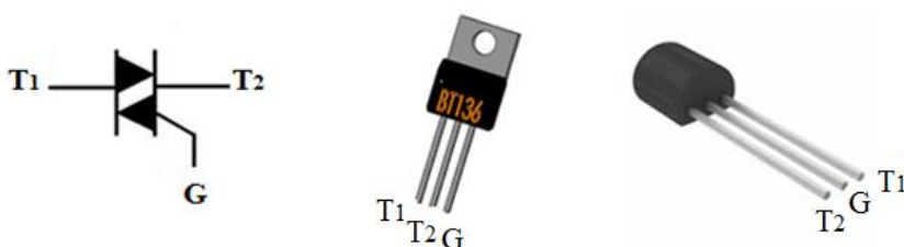
Слика 1.32: Графички симбол и приклучоци на тријак
