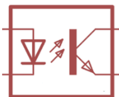
Слика 5.22: Електричен симбол на оптокаплер
