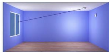
Слика 6.22: Сензор за стакло и негово поставување
