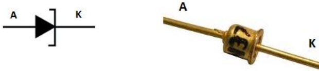
Слика 1.16: Графички симбол и приклучоци на тунел диода
