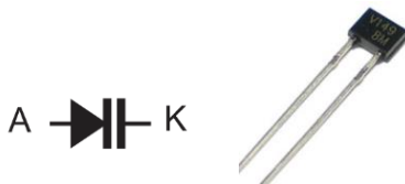
Слика 1.8: Графички симбол и реален изглед на варикап диода
