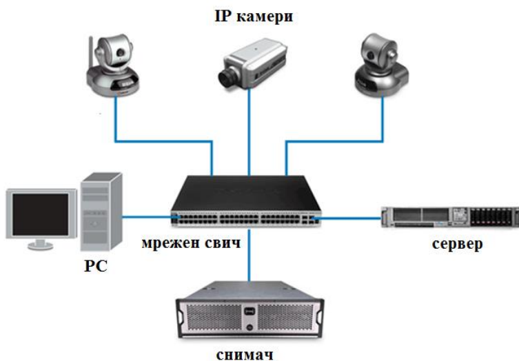
Слика 6.32: Видео-надзор со дигитални (IP-Internet Protocol) камери
