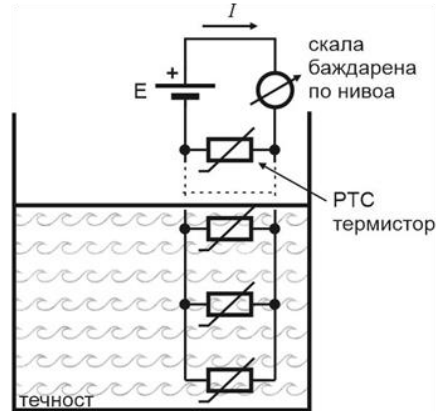
Слика 19: Коло за мерење ниво на течност
