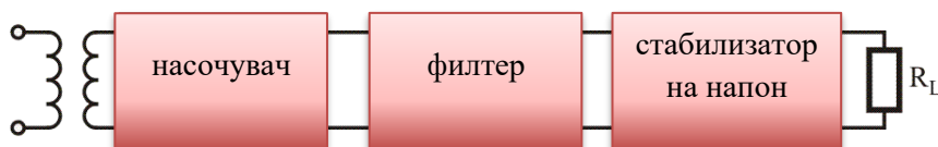
Слика 2.13: Блок-шема на исправувач
