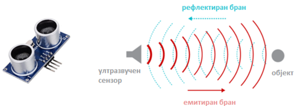
Слика 6.25: Ултразвучен сензор и негов принцип на работа
