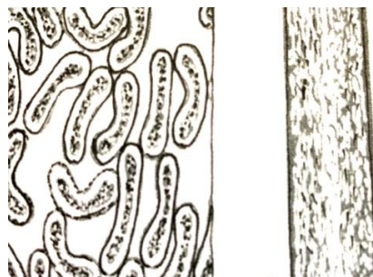
Слика бр. 89 – Микроскопски изглед на попречен и надолжен пресек на полипропиленски влакна
