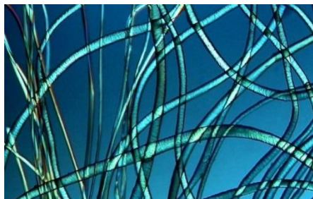
Слика бр.84 - Микроскопски изглед на ацетатни влакна и материјали од ацетатни влакна
