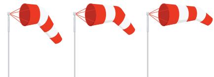
Ветроказ – инструмент за одређивање смера и јачине дувања ветра.
