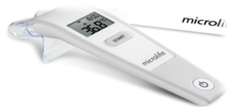
Слика 3.7 Дигитален, контактен термометар за уво
