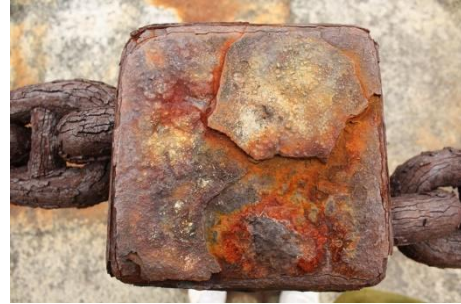
Şekil 5.7. Bir demir nesnenin korozyonu
