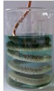
Şekil 5.1. Cu ve AgNO 3 arasında redoks reaksiyonu
