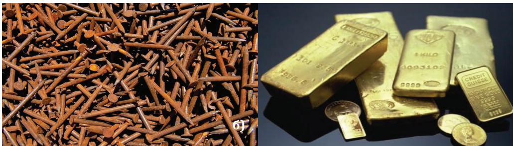
Fig. 2.4. Lëndët e hekurit në ajër ndryshken (a), por jo dhe ato nga ari (b).
