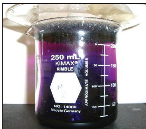
Слика 2.26. На собна температура, јодот е цврста супстанца со сива боја. Тој сублимира со виолетови пареи, кои во допир со ладен предмет преминуваат во цврста состојба. Ова својство на јодот може да послужи за негово издвојување од смеси.
