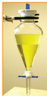
Fig. 2.27. Hinka ndarëse. Me hapjen e kapakut të poshtëm, lëngu në pjesën e poshtme mund të derdhet në enën për mbledhje.
