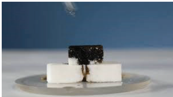
Fig. 5.11. Kur sheqeri do të shtohet në acid sulfurik të përqëndruar, ajo karbonizohet për shkak të dehidratimit të formuar.
