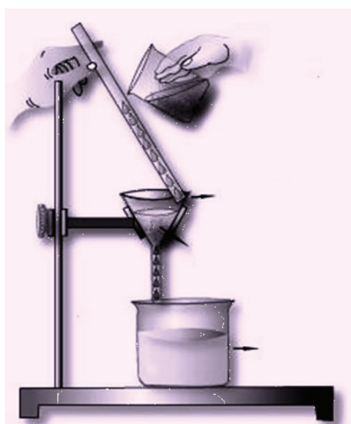
Fig 2.28. Pajisjet e filtrimit. Nëpër letren filtruese kalon lëngun e pastër gjë, e në letër filtri mbetet substanca e ngurtë.
