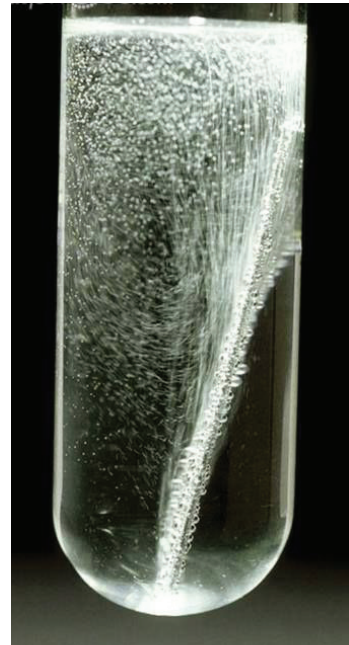
Fig. 5.16. Kur zinku reagon me HCl, lirohen fluska të hidrogjenit të gaztë.
