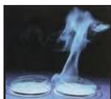
Fig. 5.8. Nëse bashkohen dy enë, ku në njëren prej të cilave përmban HCl të përqendruar, a në tretësirën tjetër, \text{NH}_3 të koncentruar, avujt e tyre (që përbëhen nga gazrat të HCl dhe \text{NH}_3 ) lidhen në mes veti duke formuar klorur amoniumi, \text{NH}_4\text{Cl} .
