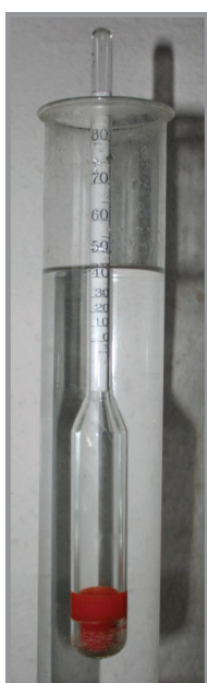
Fig. 2.3. Dendësia e lëngjeve matet me një instrument që quhet aerometër
