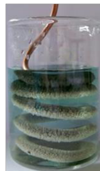
Figura 5.1. Reaksioni redoks midis Cu dhe AgNO 3
