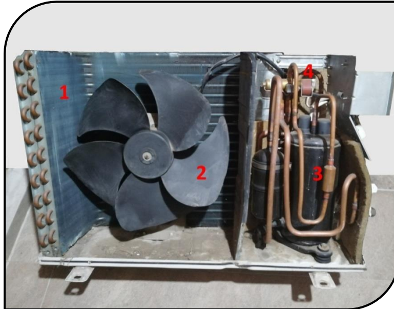
Сл.3.51. Надворешна единица: 1. кондензатор; 2. вентилатор; 3. компресор; 4. четирикрак вентил.
