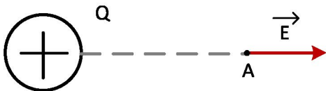
1.6.1 Pozitif elektriklenmiş yükün elektrostatik alanı
