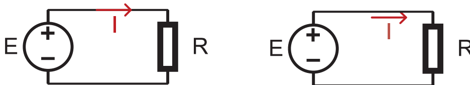
2.3 Qarku i thjeshtë me një burim dhe një konsumator, me mënyrë të ndryshme të shënimit të rrymës elektrike
