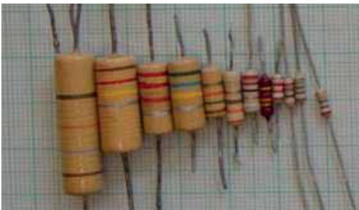
Rezistorë me rezistencë konstante (fikse), të shënuar me ngjyra, të renditur sipas fuqisë maksimale të shpërndarjes (nga më i madhi te më i vogli)
