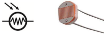
Figura 1.43: Simboli grafik dhe pamja reale e fotorezistorit
