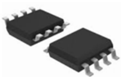
Figura 1.50: Qarqet e integruara monolite
