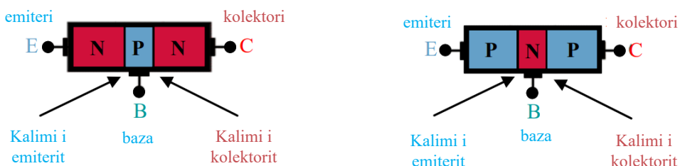
Figura 3.10: Kalimet PN të transistorit të llojit NPN dhe PNP
