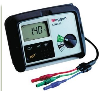
Fig. 6.5 Testuesi i impedancës së qarkut të mbyllur (Megger)
