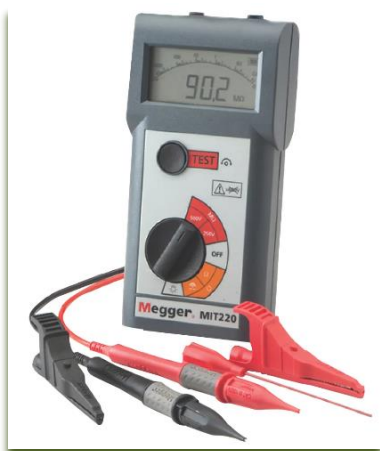
Fig. 6.8: Testuesi i izolimit dhe kontinuitetit (Megger)
