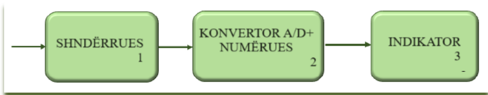
Fig. 3.6 Bllok diagrami i instrumentit matës digjital me shndërrim të drejtpërdrejtë
