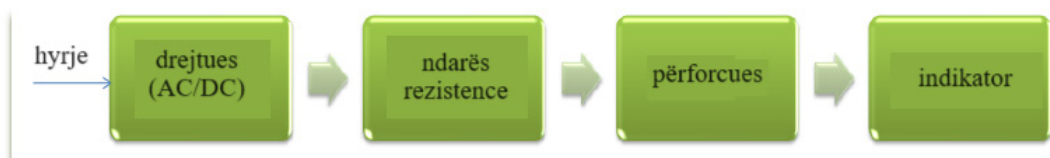
Fig. 3.27 Bllok diagrami i voltmetrit me drejtues-përforcues
