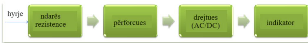
Fig. 3.28 Bllok diagrami i voltmetrit me përforcues-drejtues
