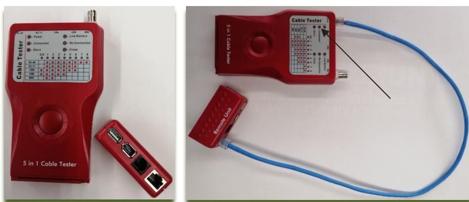
Fig. 6.36 Testimi i vazhdimësisë me testues kabllor
