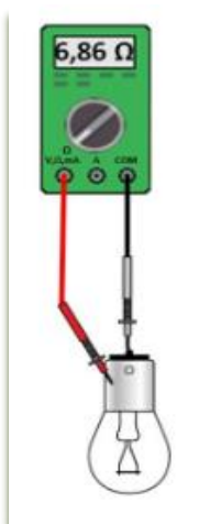
Figura 3.60 Matja e rezistencës me një multimetër digjital të rrymës
