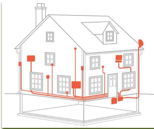
Fig. 6.1: Instalimi elektrik në objekt banimi
