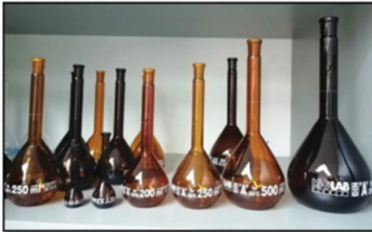
Слика 31. Стаклен лабораториски прибор изработен од темно обоено стакло
