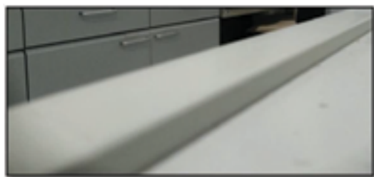
Слика 27. Раб на работна маса што е поткренат за да се спречи излевање на случајно истурени хемикалии
