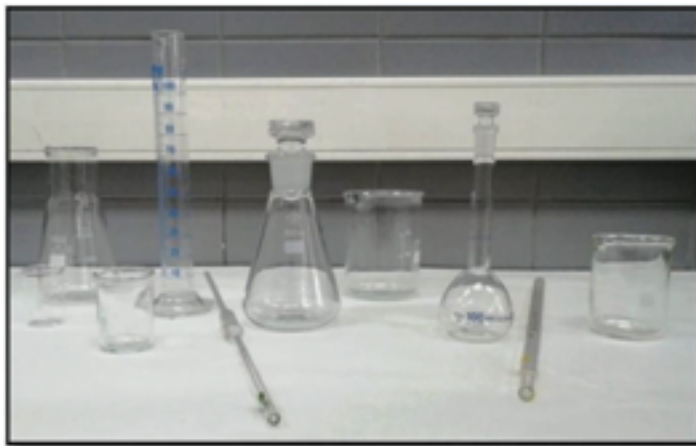
Слика 24. Различни волуметриски садови со кои може да се измери зафатнина
