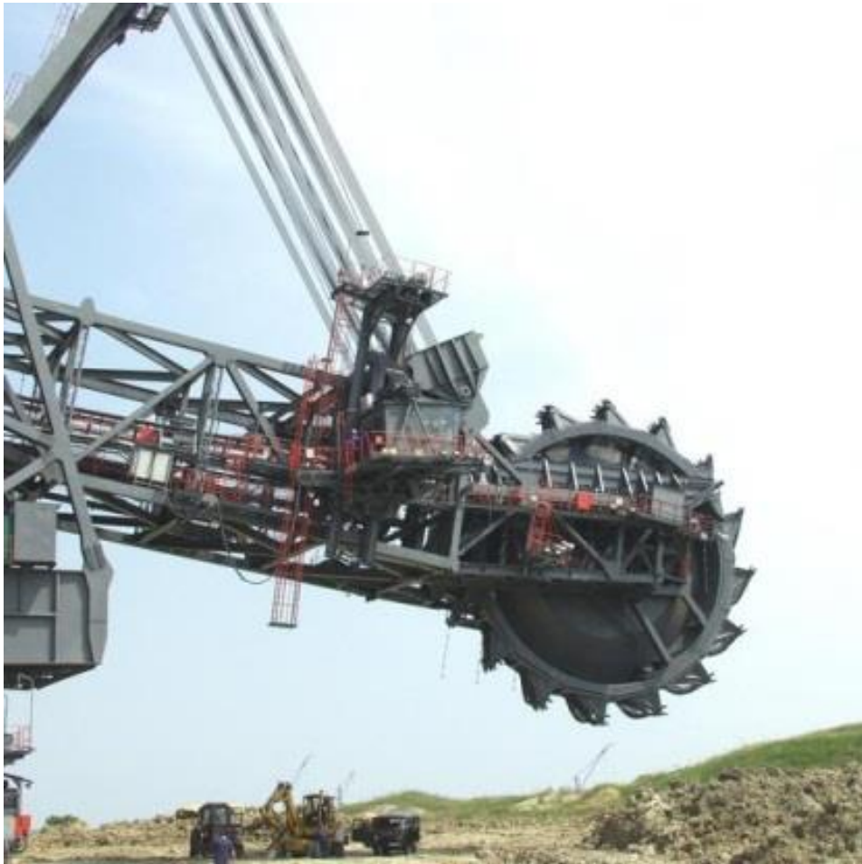
Сл.64. При работа со роторен багер целото човековото тело е изложено на вибрации
