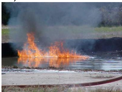
Сл.52. Запалениот бензин е полесен од водата и гори на површината
