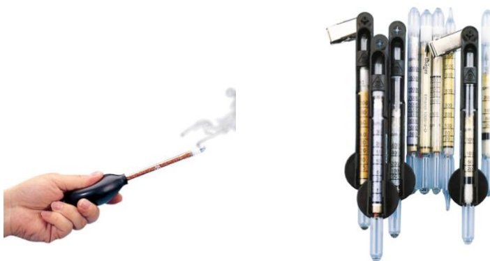
Сл.44. Мерење на метан и други гасови во јама со дрегер P/N CH25301
