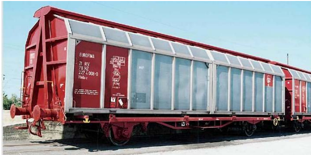
Слика 2.19. Затворени коли од специјален тип: а) со 2 оски серија Hbils – z; б) со 4 оски серија Habbins
