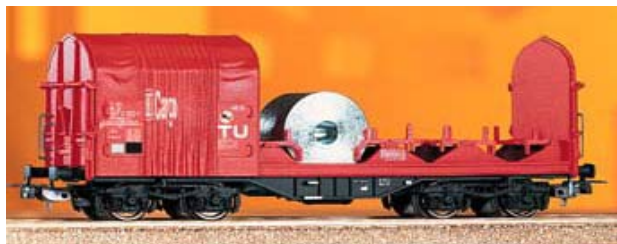
Слика 2.39. Плато-кола од специјален тип, серија Shimmns- t (за превоз на ролни лим)
