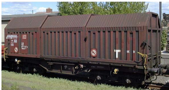
Слика 2.39. Плато-кола од специјален тип, серија Shimmns- t (за превоз на ролни лим)
