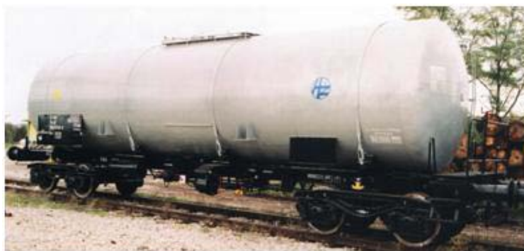
Слика 2.41. Кола цистерна, серија Zas – z, наменета за лесни нафтени деривати (бензин, серија 786 за меласа и масло за јадење и сл. )
