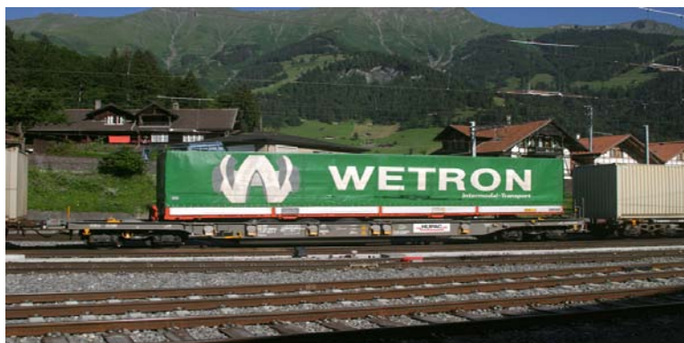
Слика 7.17. Патна седлеста полуприколка товарена на железничка кола
