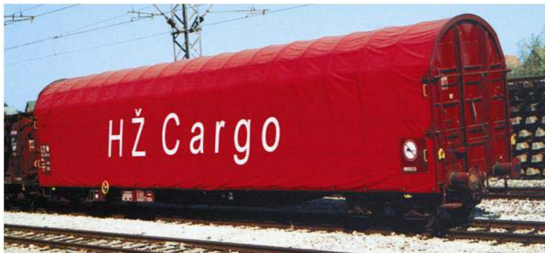
Слика 2.33. Плато-кола за превоз на товар што мора да се заштити од атмосферски влијанија, серија Rils – z
