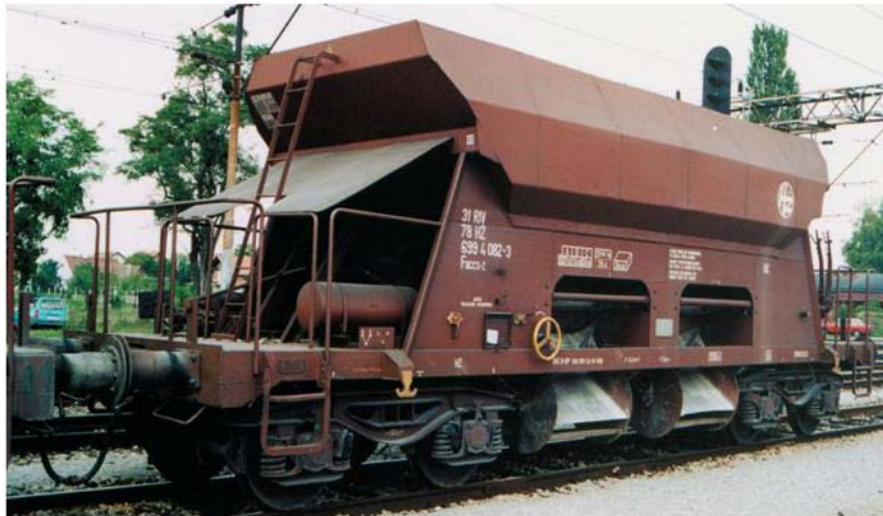
Слика 2.28. Отворени коли од специјален тип, серија Facs – z
