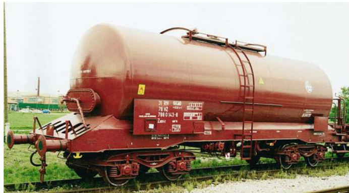
Слика 2.40. Кола цистерна за превоз на густы течности, серија Zaes- z, опремена со парни грејачи кои се загреваат при истовар
