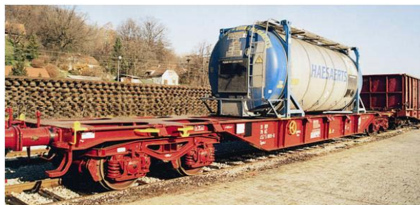
Слика 2.38. Плато-кола од специјален тип за превоз на контејнери, серија Sgnss-z
