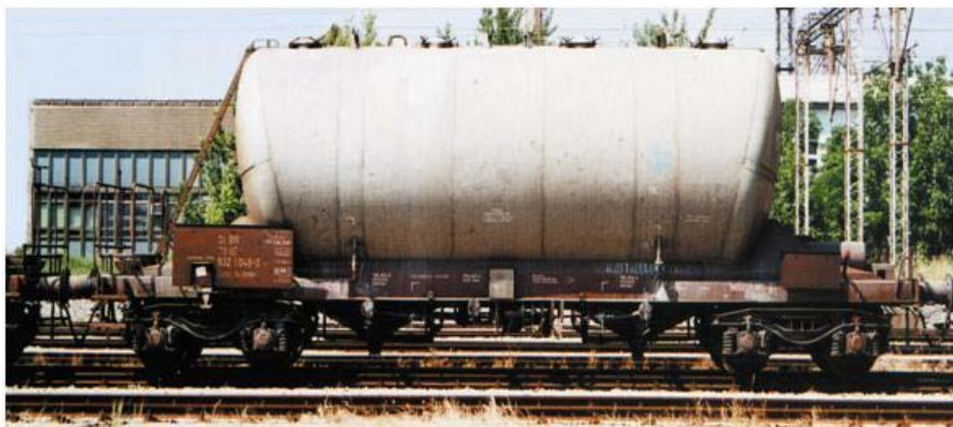
Слика 2.46. Специјална кола, серија Уасz- z, за прашести и зрнести пратки до 5 тт (цемент, калциумова сода и др.)
