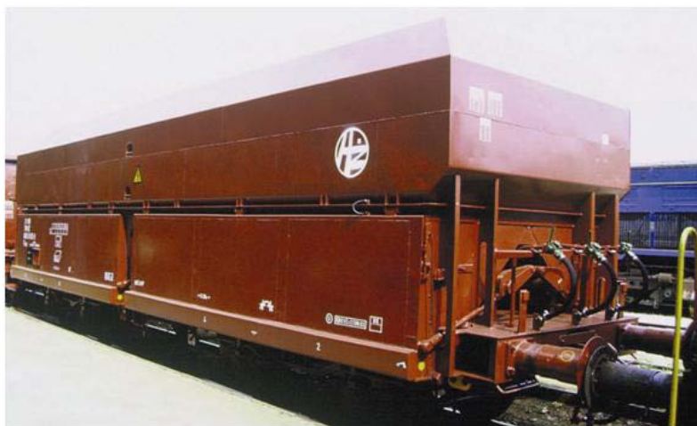
Слика 2.29. Отворени коли од специјален тип, серија Fals – z
