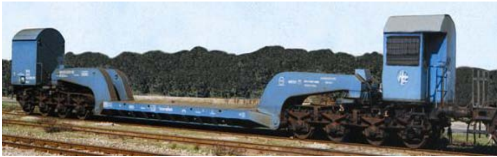
Слика 2.44. Специјална кола со 8 оски, серија Уаа1 – z, наменета за превоз на предмети со поголема маса и димензии (до 105 t)
