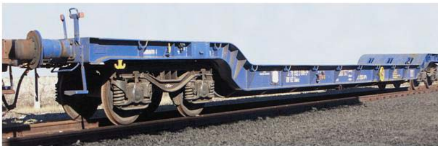
Слика 2.43. Специјална кола со 4 оски, серија Uais- z, наменета за товари кои го пречекоруваат товарниот профил кај стандардните плато-коли
