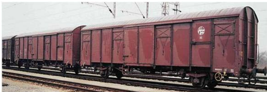
Слика 2.20. Кола со две оски серија Hrr – s со отвори за проветрување
