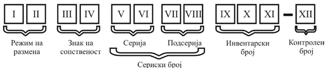
Слика 2.16. Значење на цифрите во индивидуалниот број на колите
