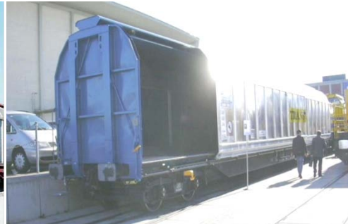
Слика 2.19. Затворени коли од специјален тип: а) со 2 оски серија Hbils – z; б) со 4 оски серија Habbins
