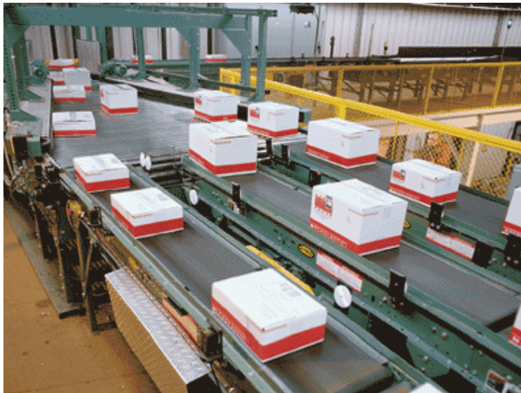
Слика 7.22. Транспортер во вид на лента
