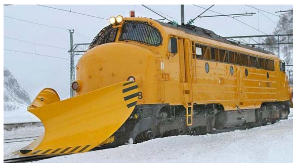
Слика 4.4. Помошни возови (за кревање на железнички возила во случај на вонредни настани и за чистење на снег)
