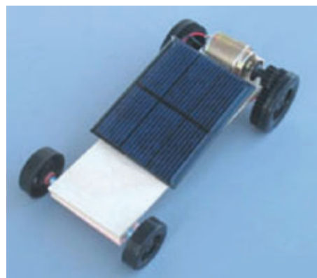
Модел возила са електричним мотором на сунчеву енергију
