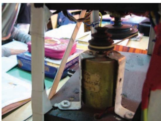
*Примена на електромотор со преносен механизам*
