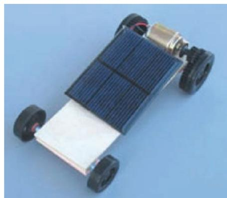
*Модел на возило со електричен мотор на сончева енергија*
