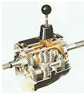
Менувачот кај автомобилот е сложен уред со запченици. Со промена на положбата на менувачот се менува брзината на движењето на моторот. Промената на брзината на движењето од моторот преку други елементи дејствува на брзината на движењето на тркалата од автомобилот.
