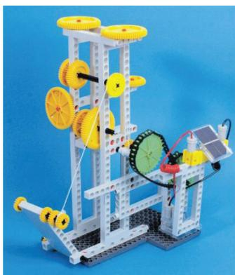
Конструкција на модел каде преносот на силата се врши со механизам со пластични запчаници.
