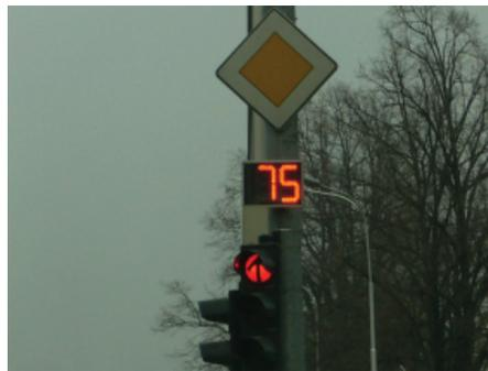
На сликата е прикажан дополнителен електронски светлосен уред со кој се покажува времетраењето на наредбата на светлосниот знак на семафорот. Доколку времето на чекање е подолго, возилото може да се изгаси. Со тоа се намалува загадувањето на човековата средина.
