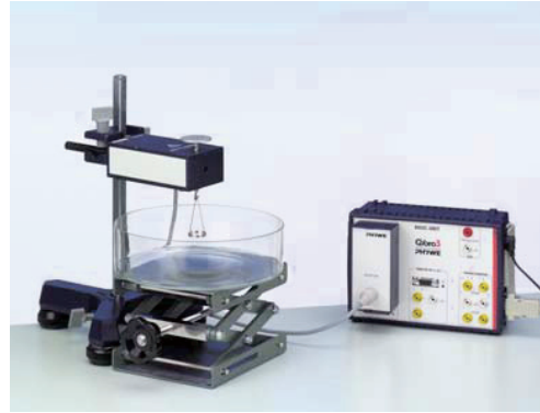
Şekil. 5. Yüzüğü ayırma yöntemi ile yüzey gerilimi sabitesini ölçmek için deney düzeneği
