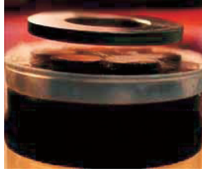
Şekil 9. Metal yüzüğü süperiletken mıknatısın mıknatıs alanında uçar (mıknatıs kuvveti gravitasyon karşılar)
