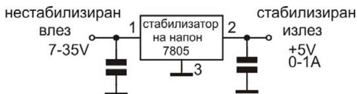
6.14: Приклучување на интегриран стабилизатор на напон.
