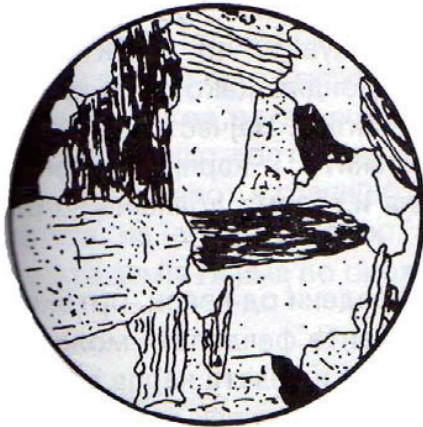
Сл. 20а Зрнеста структура кај гранитот микроскоп
