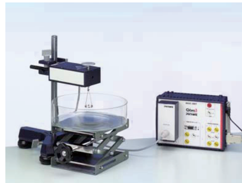
Fig. 5. Prova eksperimentale për matjen e koeficientit të tensionit sipërfaqësor me metodën e ndarjes së unazës.
