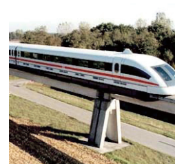
Fig. 10. MAGLEV është treni që punon në principin e levitacionit magnetik (qëndron pezul mbi binarët)
