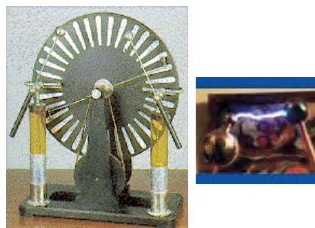
Fig. 5. Me aktivizimin e makinës së influencës të dy poletg e saj elektrizohen deri te tensione të larta, kështu që ndërmjet tyre mund të parfaqitet xixë (te fotografia djathtas) Duke shfrytëzuar dukujrinë e elektrizimi
