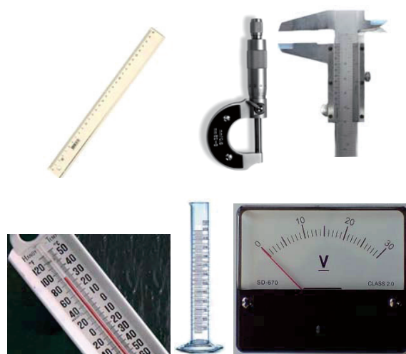
Fig.1. Matëse të ndryshëm: lartë, instrumente për matjen e gjatësisë – vizor, vint mikrometrik dhe shubler; poshtë: termometër, menzurë dhe voltmetër
