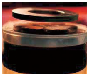
Fig. 9. Unaza metalike qëndron pezul në fushën magnetike të superpërçueshmërisë (forca magnetike e kompenzon forcën e gravitacionit)
