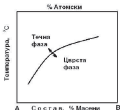
Слика 4.2 Двокомпонентен дијаграм состав-температура, во кој е претставена линија што ја прикажува рамнотежата меѓу две фази (течна и цврста фаза)
