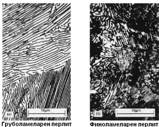
Слика 6.24 Металографски снимци на структурата на груболамеларен (а) и финоламеларен (б) перлит
