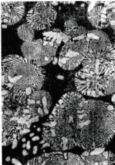
Слика 3.9 Металографска снимка на микроструктурата на евтектичка легура на Cd+Sn, кристализирана со брзо ладење. Видливи евтектички колонии, а темното поле - примерни зрна на Cd
